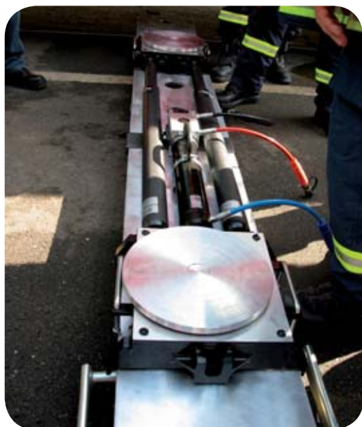
Sestava zařízení DUO pro boční posun s můstkem délky 3,3 m
