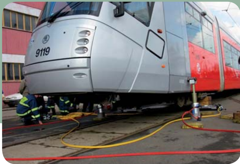
Zvedání tramvaje 14T pomocí hydraulických zvedáků
